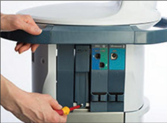
7. 如图所示在底部的右侧插入带有连接开口的面板（随模块一起提供），听到咯嗒声表示就位。左侧插入空白面板。
