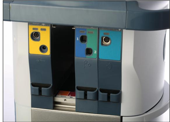
4. 如图所示，将模块插入左侧的第三插槽。小心地将模块插入插槽内，首先插入 32 插脚 (2 x 16)。
